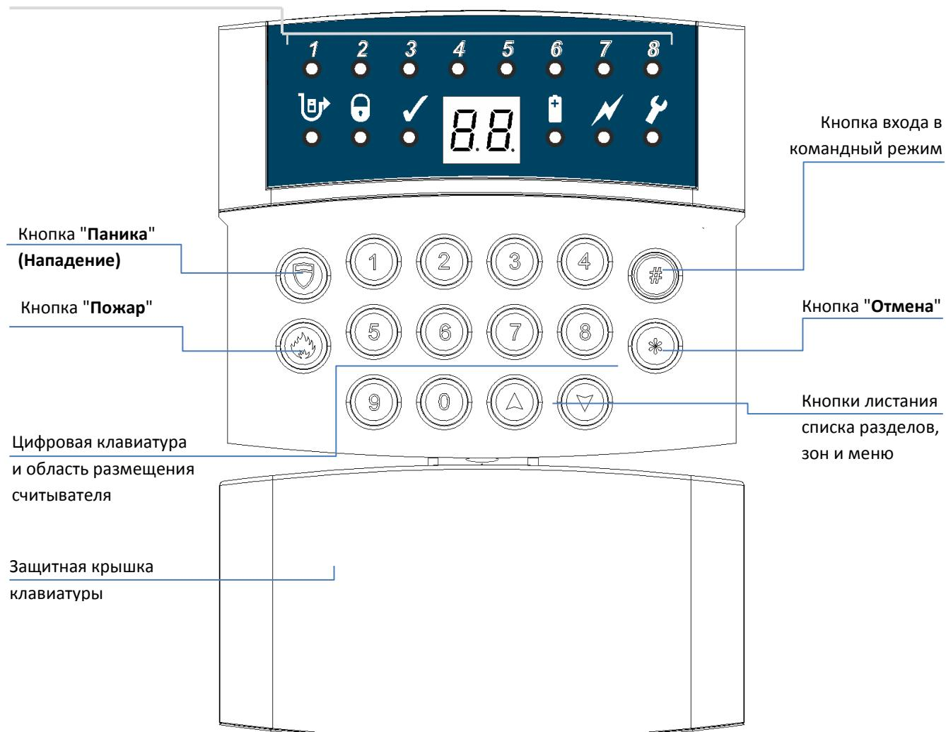
Рис. 15. Беспроводная клавиатура M4064KP
