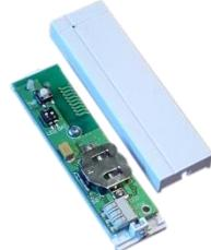
Рис. 4. KC131PC Магнитоконтакт и устройство управления светодиодом и СМК
