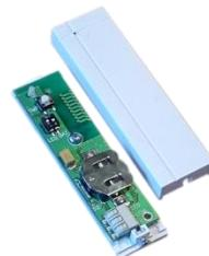
Рис. 4. KC131PC Магнитоконтакт и устройство управления светодиодом и СМК
