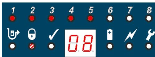
Рис. 22. Ввод нового кода доступа
