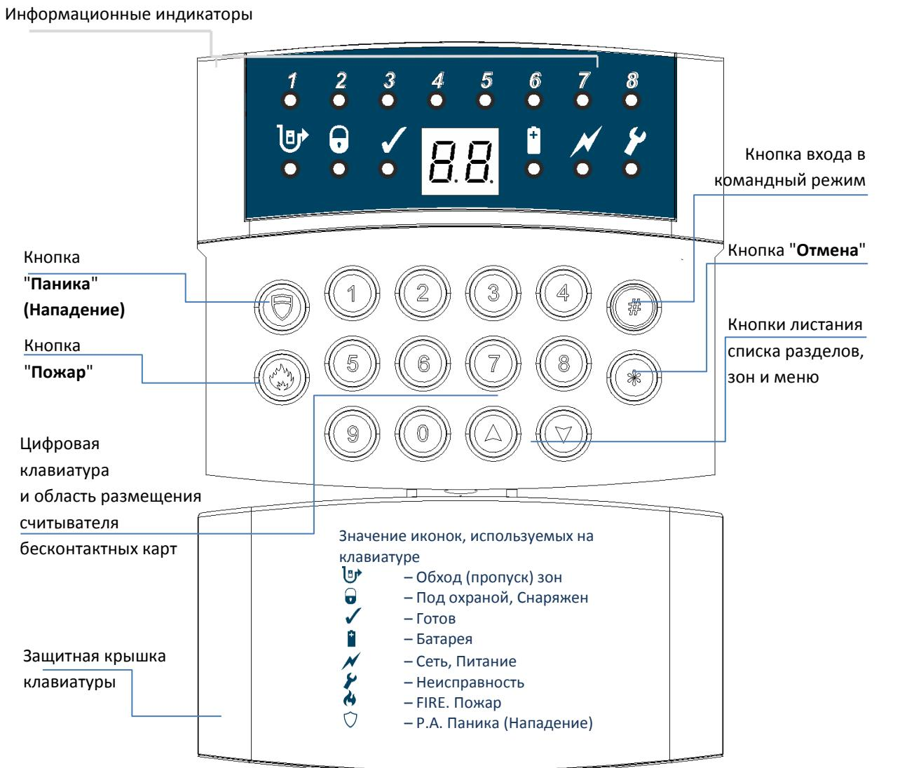
Рис. 15. Беспроводная клавиатура M4064KP
