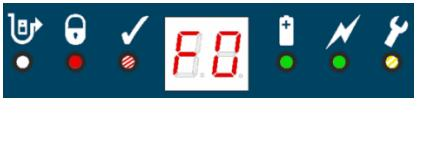
Системная тревога означает, что открыт корпус прибора или беспроводного датчика, либо ретранслятор МШР+ извлечен из розетки.
