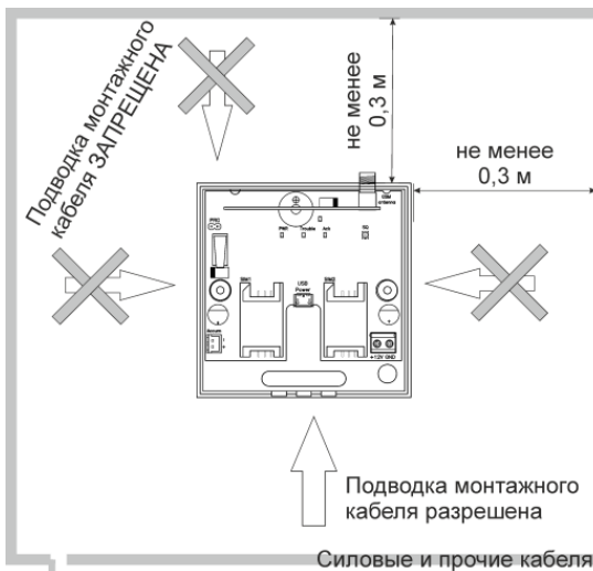
Рис.5. Установка базового блока.
